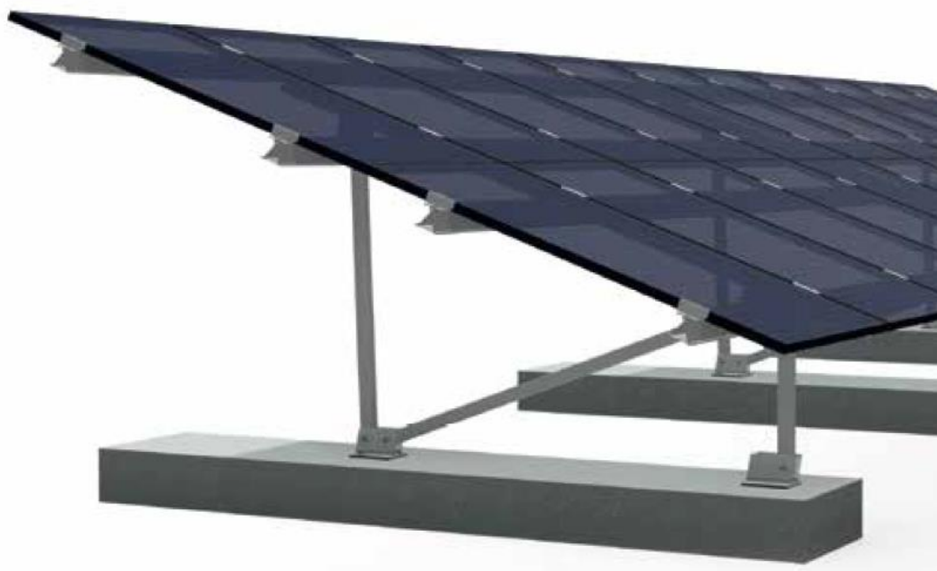
Rys. 7. Ilustracja przykładowego systemu montażowego.
